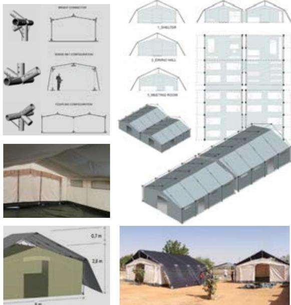
Multipurpose Tent, struttura modulare che ottimizza il volume utile interno
