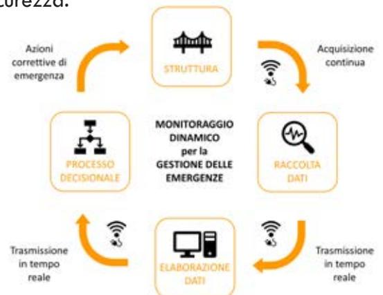
Flusso di lavoro per il monitoraggio dinamico delle vibrazioni strutturali
