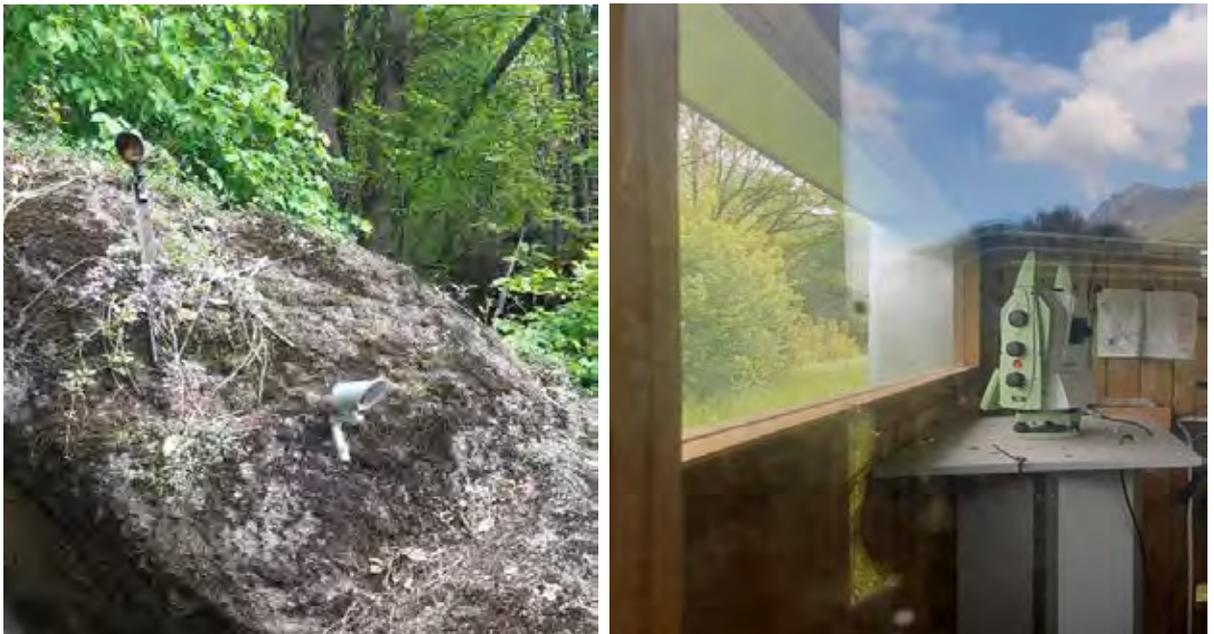
*Monitoraggio topografico di movimenti franosi mediante stazione totale e prismi collocati in sito.*
